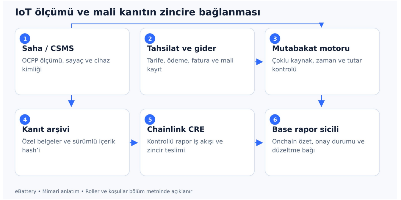
Şekil 10. IoT ölçümü ve mali kanıtın zincire bağlanması
